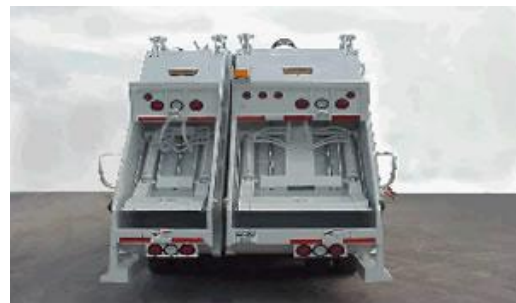
Figura 72. Camiones compactadores con secciones para la selección de residuos sólidos
