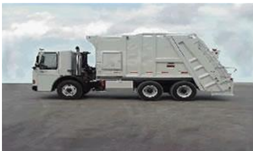
Figura 72. Camiones compactadores con secciones para la selección de residuos sólidos
